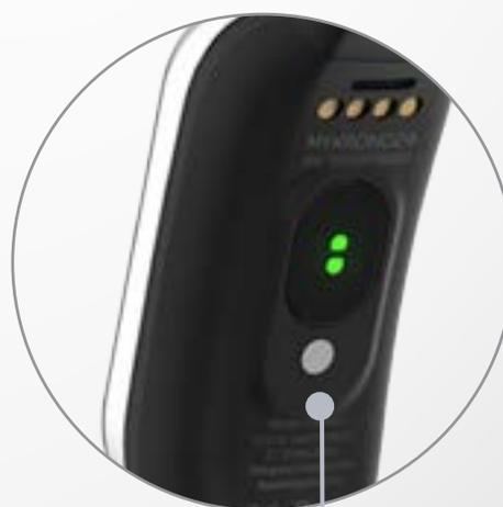
Sensore ottico della frequenza cardiaca e sensore della temperatura corporea
