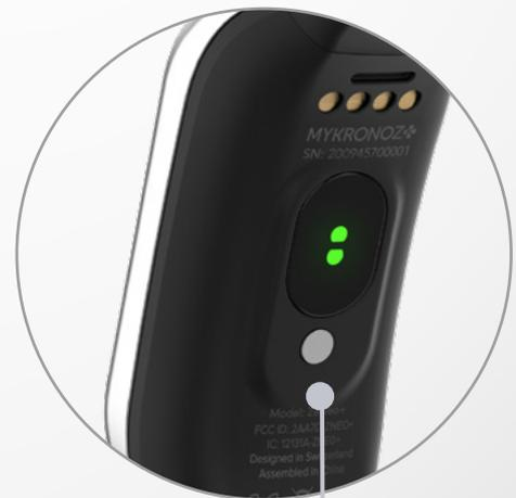
Capteur de fréquence cardiaque et de température corporelle
