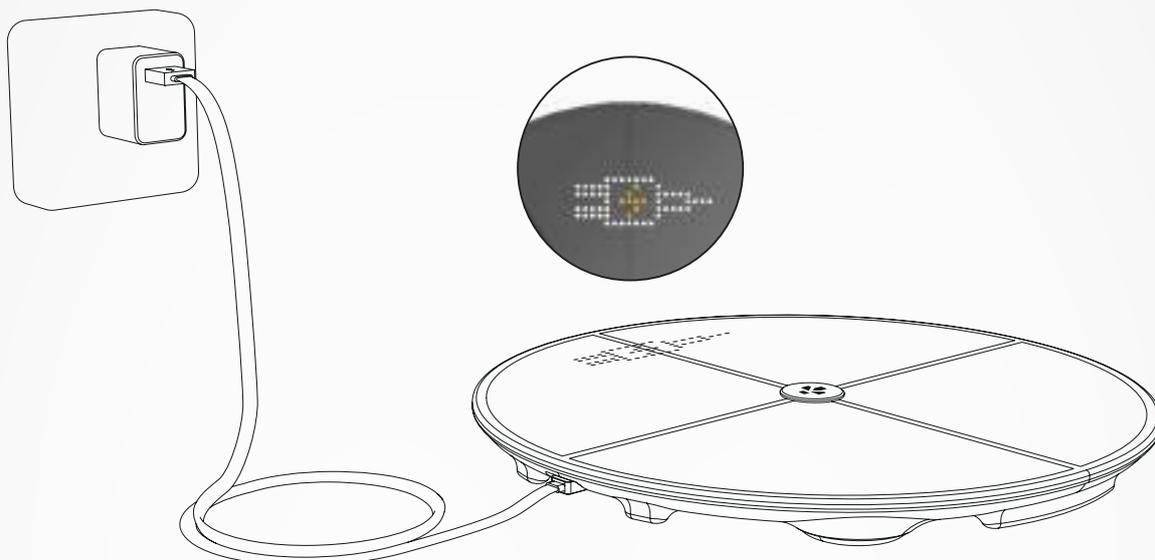
Inserire MyScale in una fonte di alimentazione utilizzando il cavo USB-C fornito. MyScale mostrerà un'icona per indicare lo stato di carica. La carica completa della batteria può impiegare fino a 5 ore.
